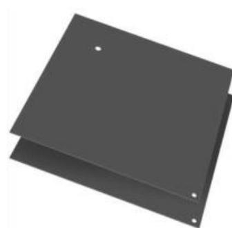
**4** Déterminer la position des trous en posant des tuiles solaires entières dessus, côté soleil vers le bas, percer des trous de 24 mm et 16 mm. Les trous du bas doivent être à plus de 13 mm du bord de la tuile.
